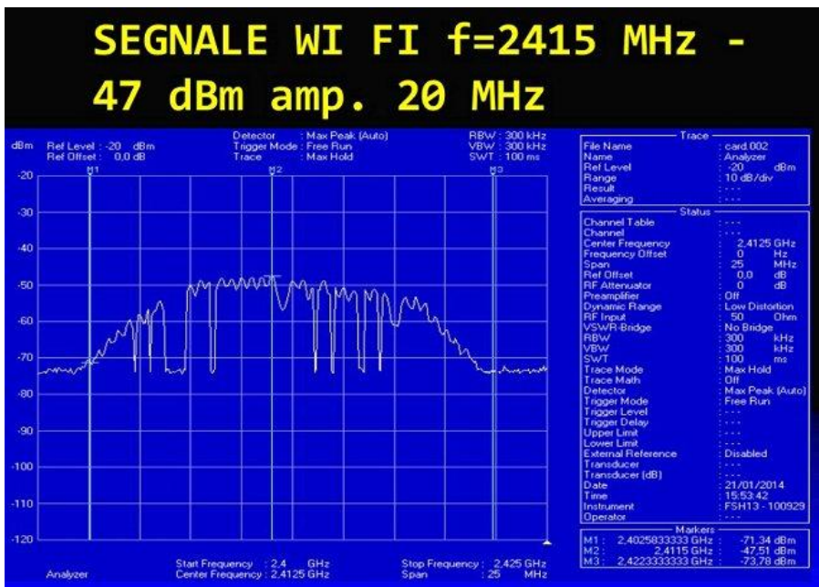
Il segnale Wi-Fi visto da un analizzatore di spettro. (© F. Marinelli)
